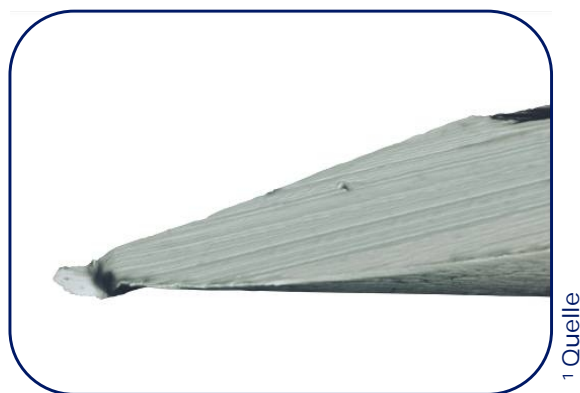
370-fache Vergrößerung einer wiederverwendeten Insulinpen-Nadel
