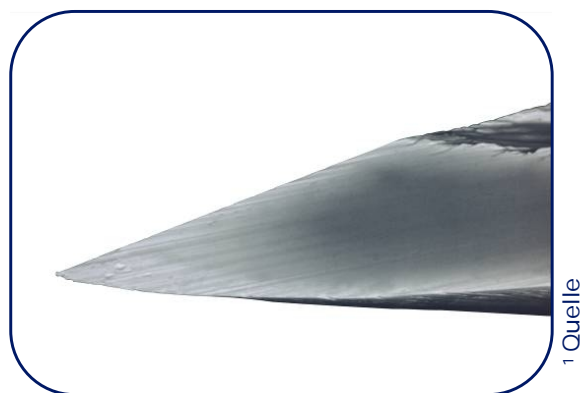
370-fache Vergrößerung einer unbenutzten Insulinpen-Nadel
